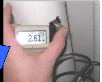
Bildet viser en av ultralydmålingene som ble foretatt. Original tykkelse er 5-6mm. Her målt til 2,61. Flere målinger er gjort av områder med 0 i utslag. Da er alt metall vasket bort og grafitt er det eneste som står tilbake.
